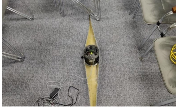
Şəkil 4. CMG-5TD akseleroqrafının diktin üzərində görünüşü
